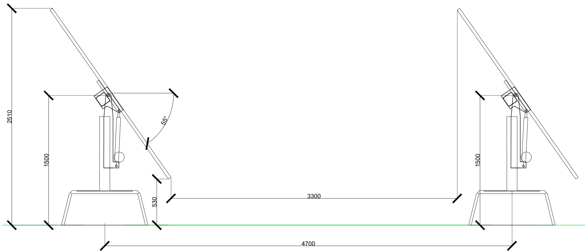
VISTA LATERALE - TRACKER SOSTENUTO DA PLINTI IN CALCESTRUZZO PREFABBRICATO
