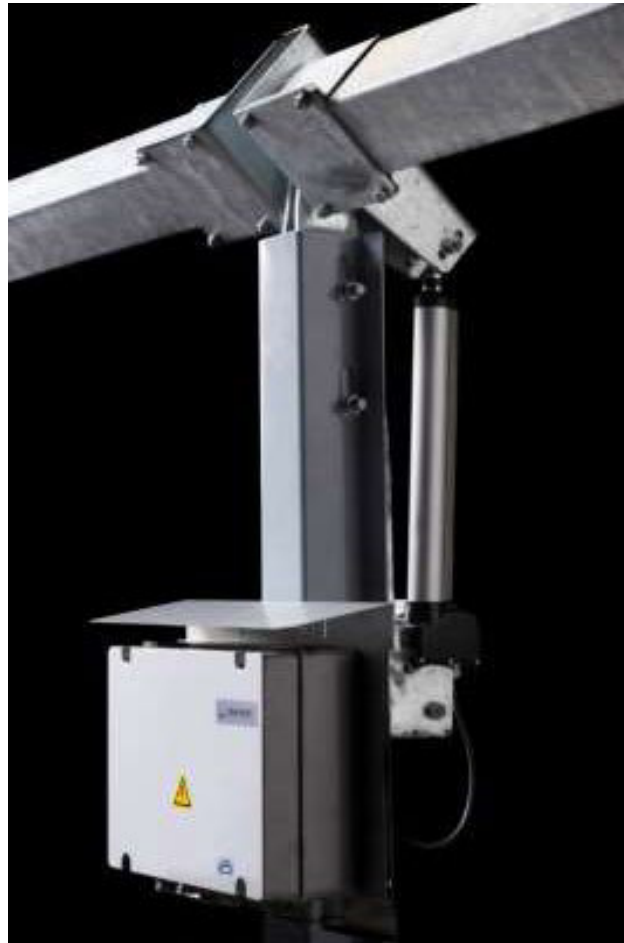
Figura 51: Dettaglio attuatore lineare CA e scheda di controllo SKC
