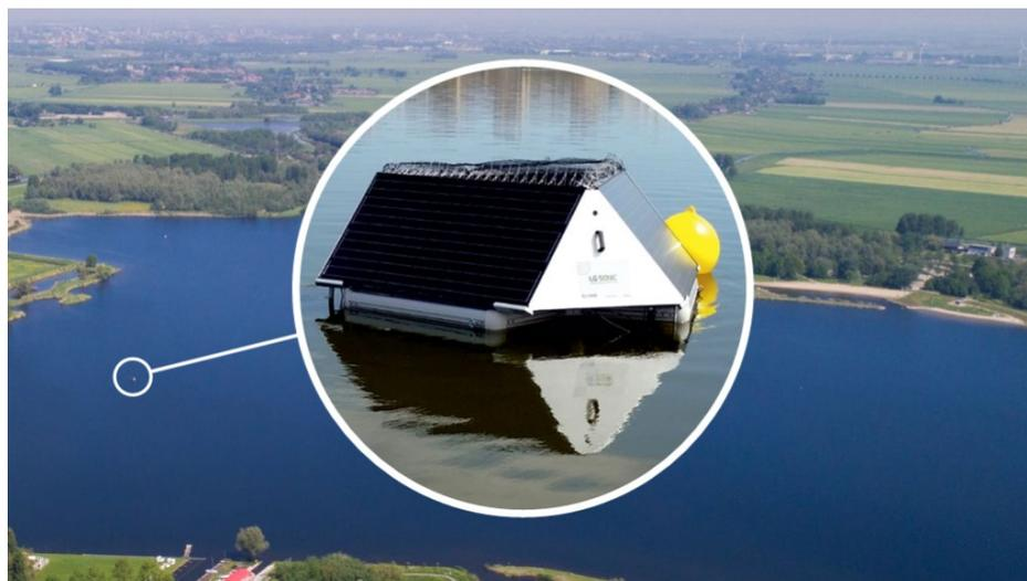
Tutte le apparecchiature necessarie sono installate su un unico strumento, compresi gli strumenti necessari al monitoraggio delle acque, i dati vengono trasmessi ad un server che elabora e reinvia alle stesse boe il programma riadattato alle condizioni, impostando le frequenze e i cicli di emissione degli ultrasuoni.
