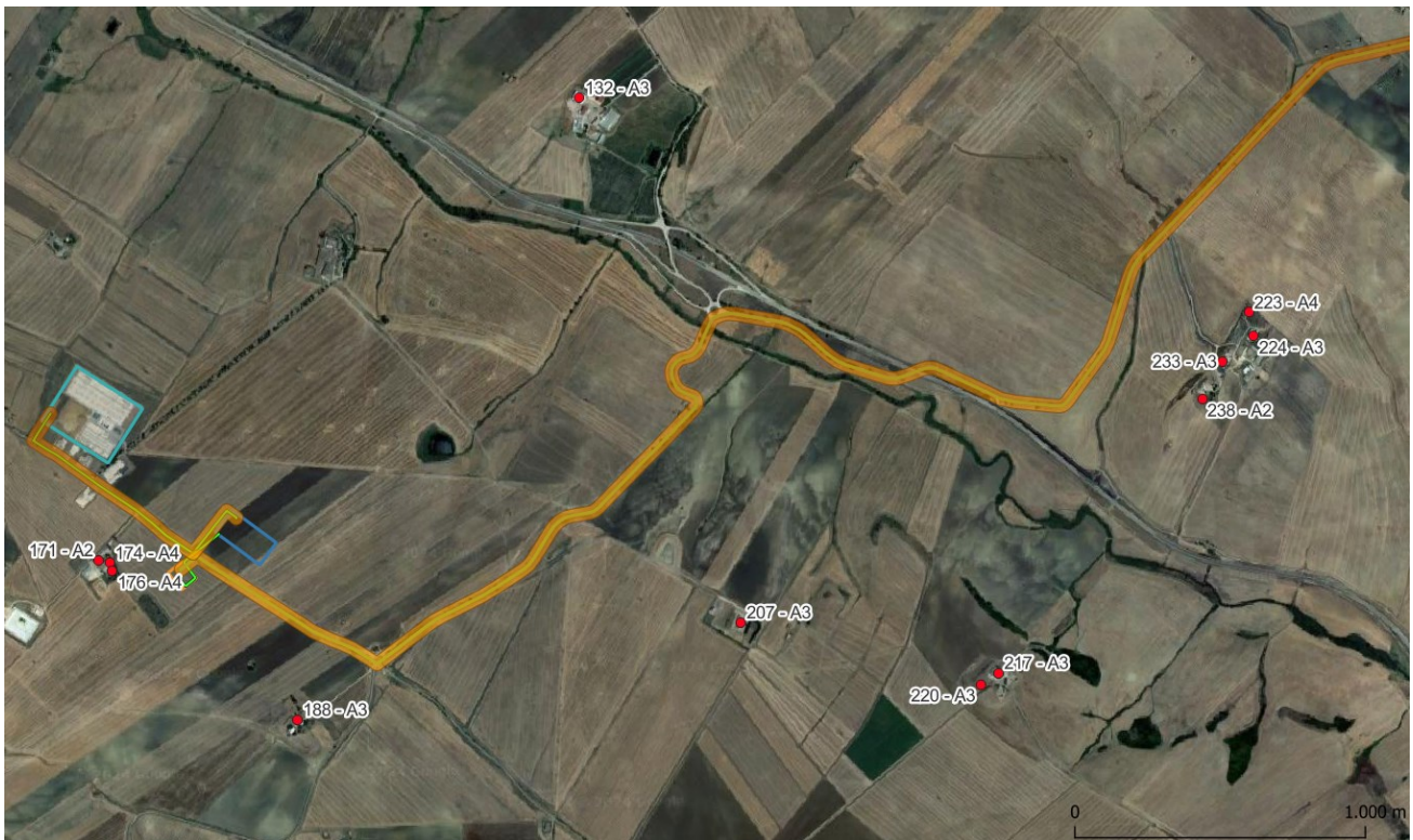
Percorso del cavidotto e fascia nella quale si verificherà un rumore superiore o uguale a 70 dB(A)
