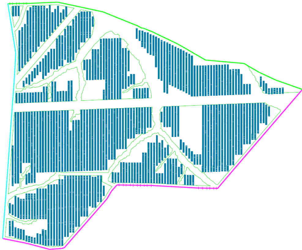
Fasce di mitigazione area impianto
