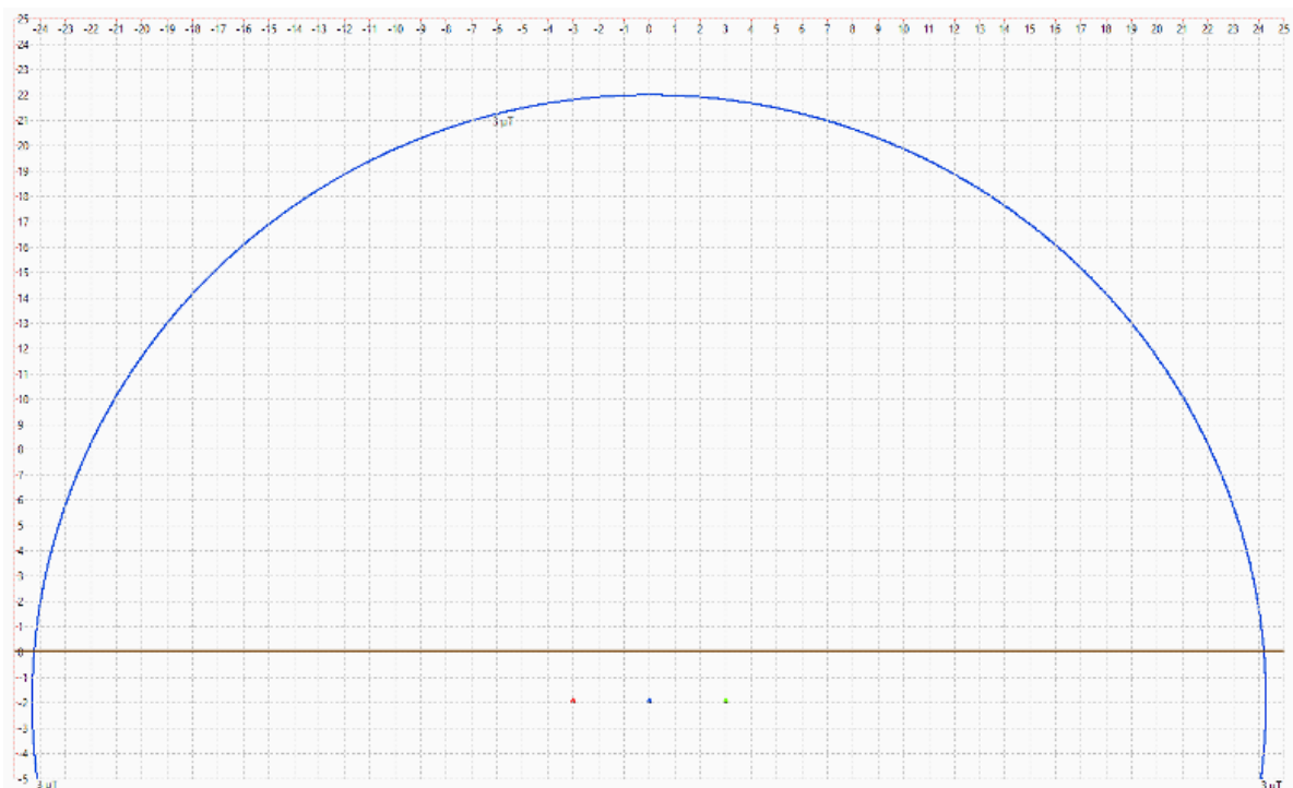
Figura 13: Curva isolivello del campo magnetico a 3 \mu\text{T} in una sezione longitudinale alla configurazione di posa descritta
