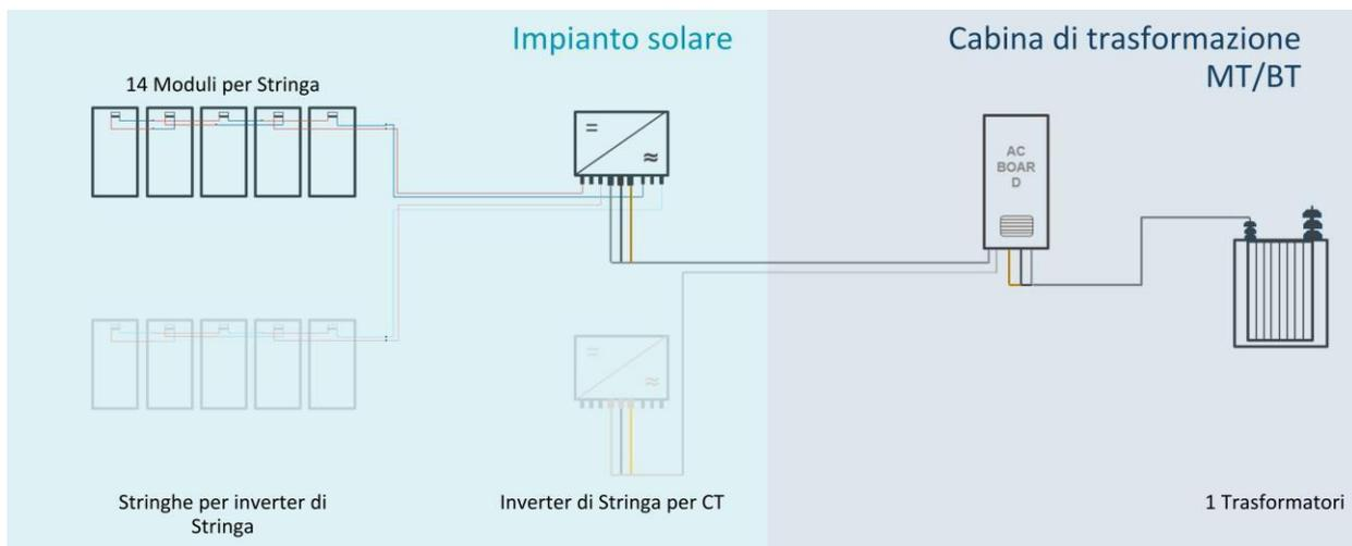
Figura n. 24 - Schema di configurazione elettrica semplificata
