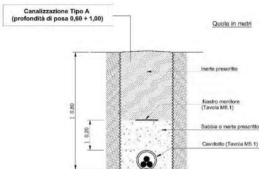
Figura n. 31 - Sezione di posa cavidotto interno
