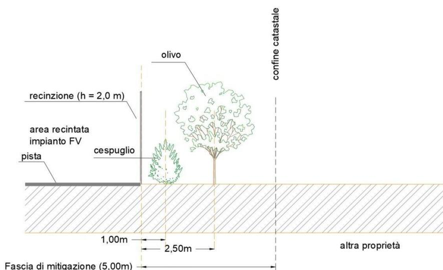
*Figura 68 – Stralcio di sezione dell'area perimetrale dell'impianto*
