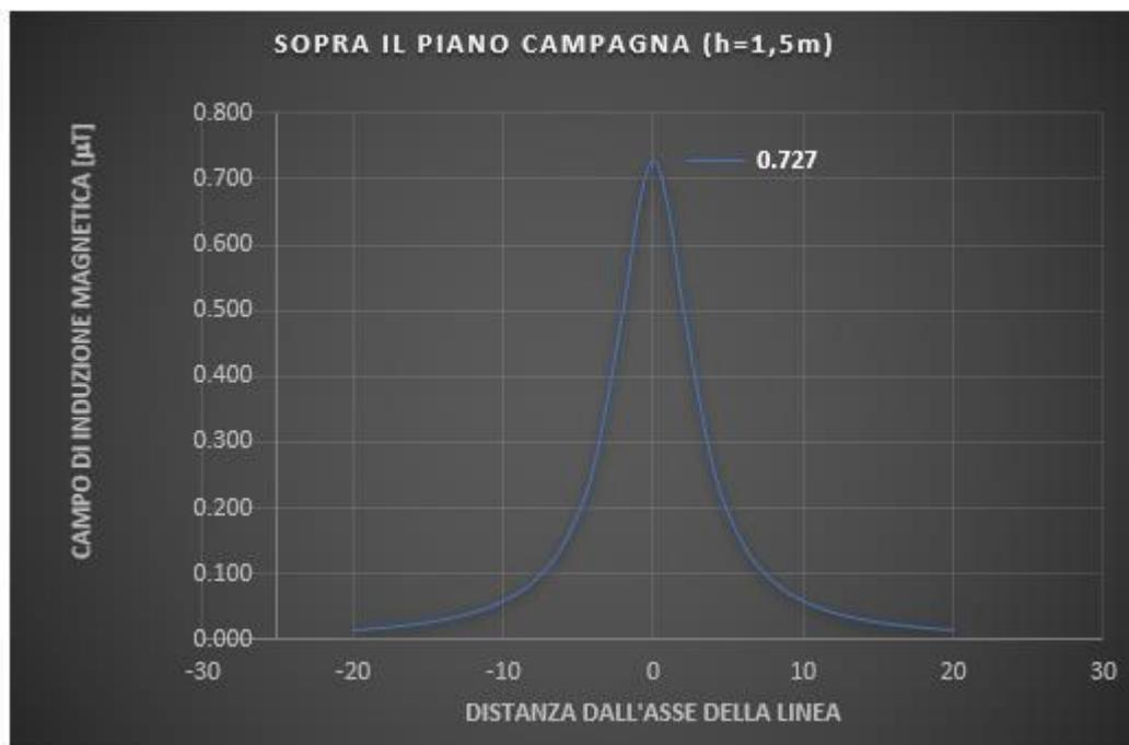
Figura n. 88 - Campo elettromagnetico a 1,5 m sopra il suolo
