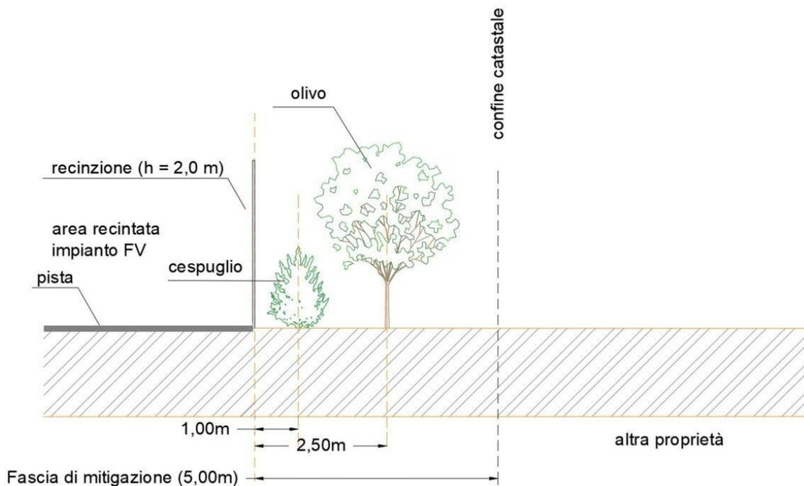
Figura n. 42-Stralcio di sezione dell'area perimetrale dell'impianto.
