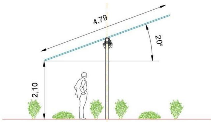
Figura n. 33-Area di incidenza minima del modulo fotovoltaico.
