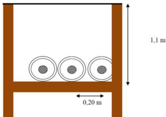
Figura n. 89 - Schema di posa per la simulazione
