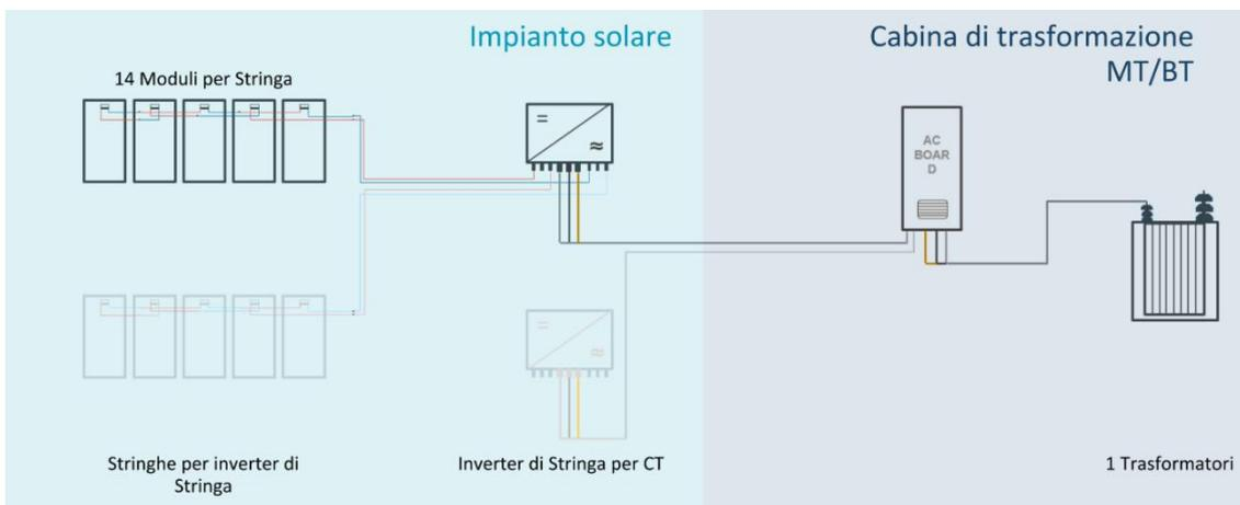
*Figura n. 3 - Schema di configurazione elettrica semplificata*
