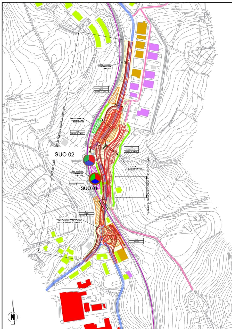
Figura 8 – stralcio cartografico con ubicazione dei punti di monitoraggio previsti per la componente SUOLO e SOTTOSUOLO
