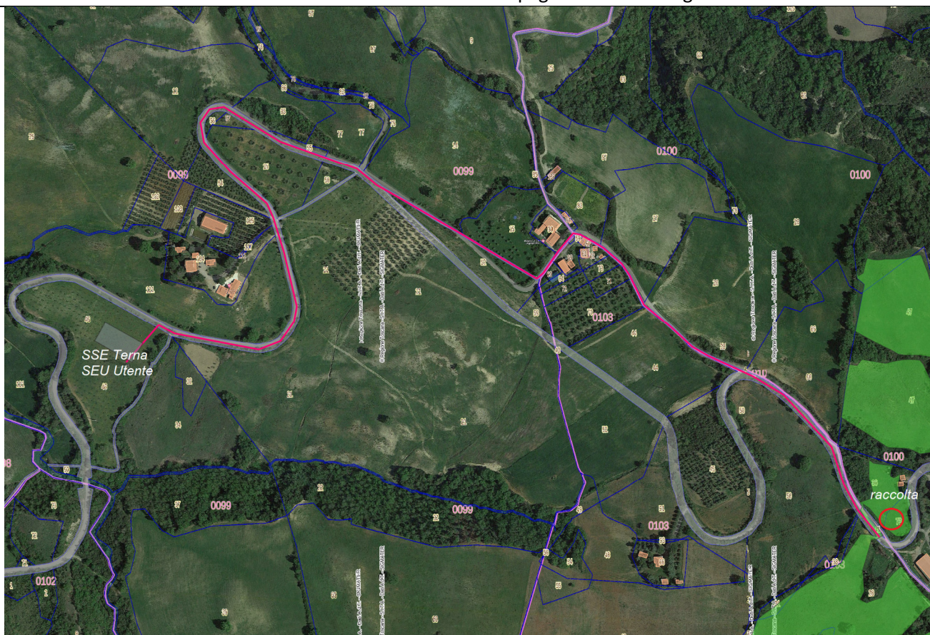
Figura 12 – Cavidotto di connessione su ortofoto
