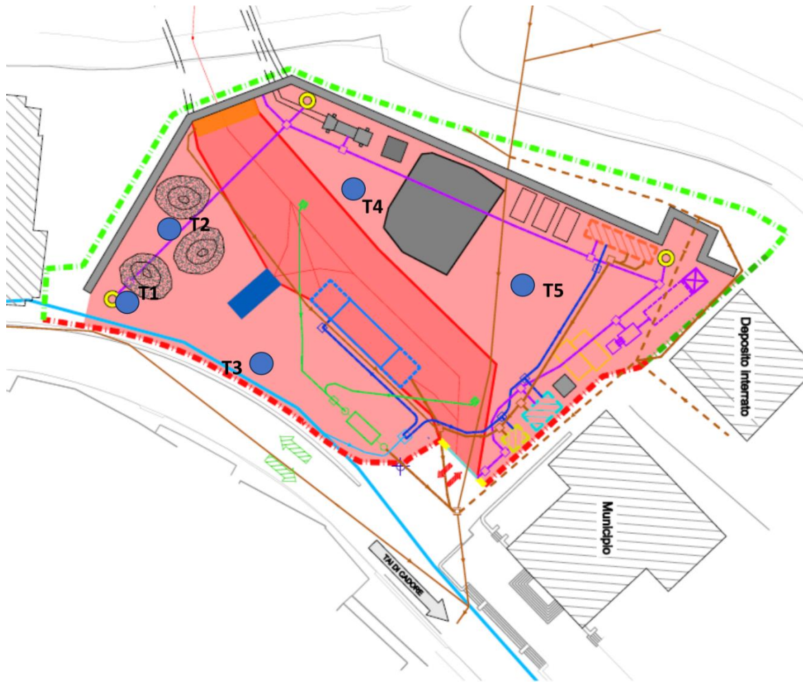
Figura 6-1 - Localizzazione punti di indagine Trivellate Cantiere Valle Est
