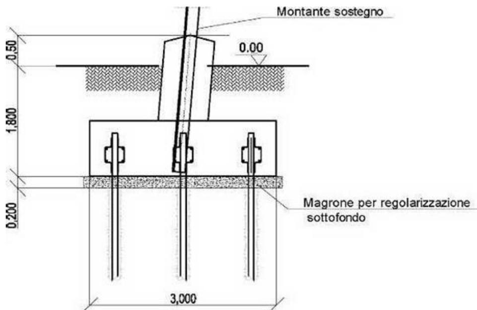
Figura 6 - Disegno costruttivo di un micropalo
