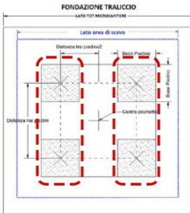
Figura 10 - Schematico di fondazione: i rettangoli rossi indicano il posizionamento dei saggi archeologici
