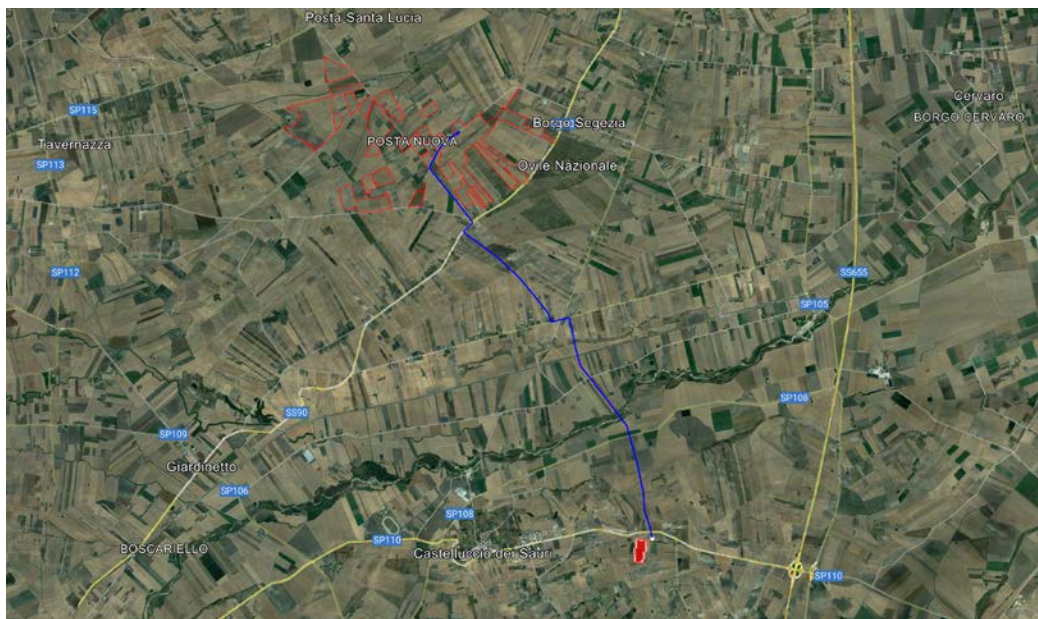
Figura 2 – Tracciato cavidotto MT verso SE
