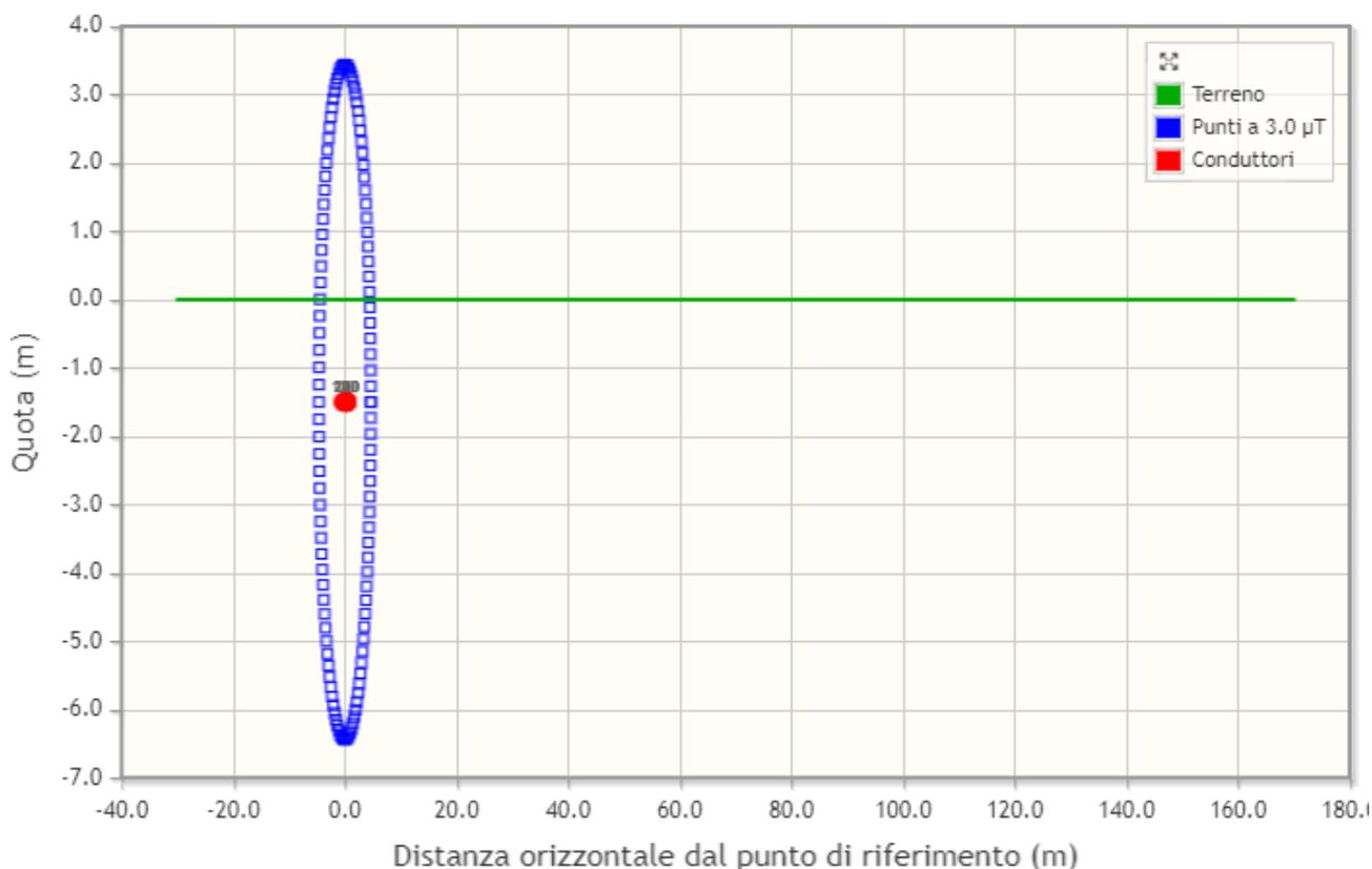
Si può quindi considerare che l'ampiezza della fascia di rispetto con valore del campo magnetico indotto inferiore a  $3\mu\text{T}$  sia pari a 5m, a cavallo dell'asse del cavidotto.
