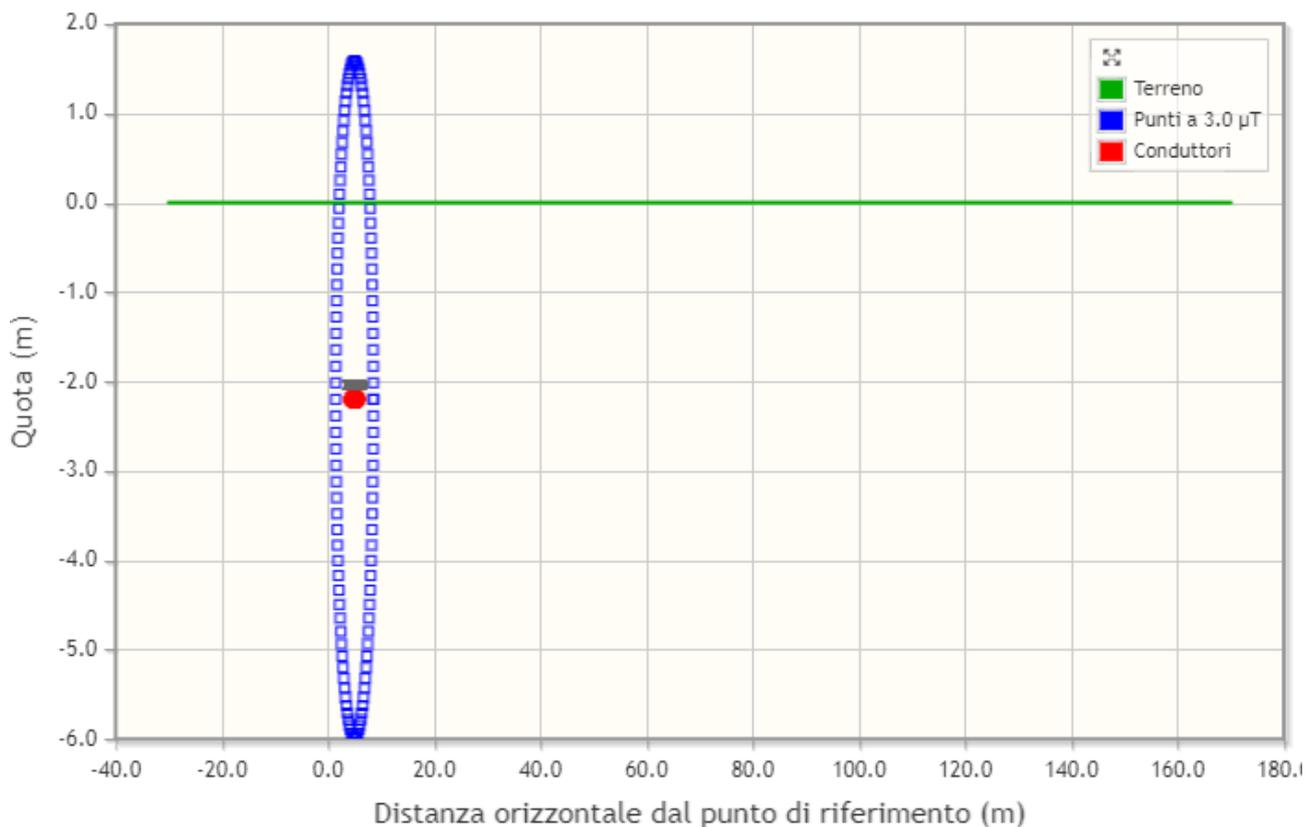
Si può quindi considerare che l'ampiezza della fascia di rispetto con valore del campo magnetico indotto inferiore a  $3\mu\text{T}$  sia pari a 3,7m, a cavallo dell'asse del cavidotto.
