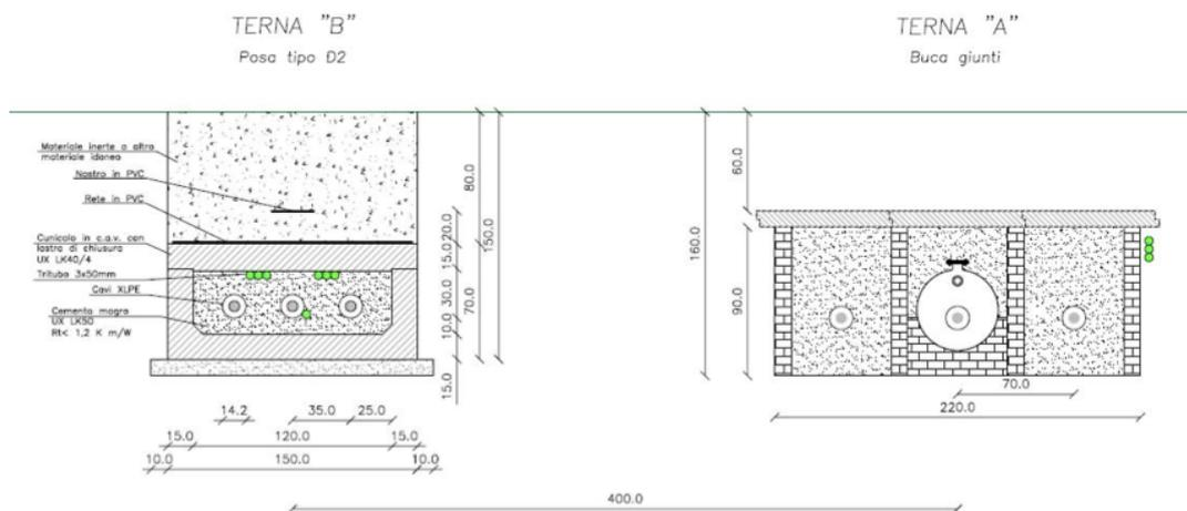
Figura 2: Affiancamento tra due linee interrate AT
