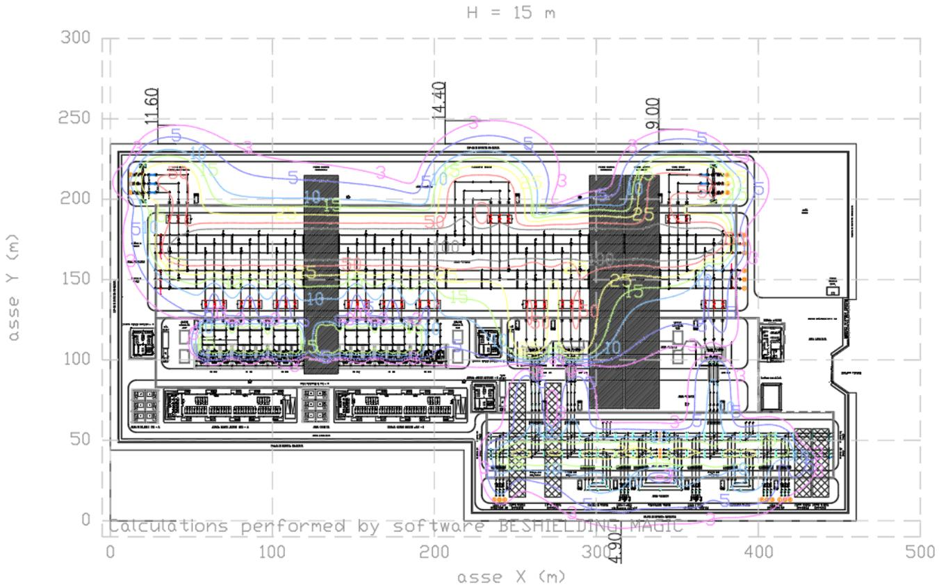
Figura 9 – Livelli di campo magnetico a 15 m dal piano della stazione
