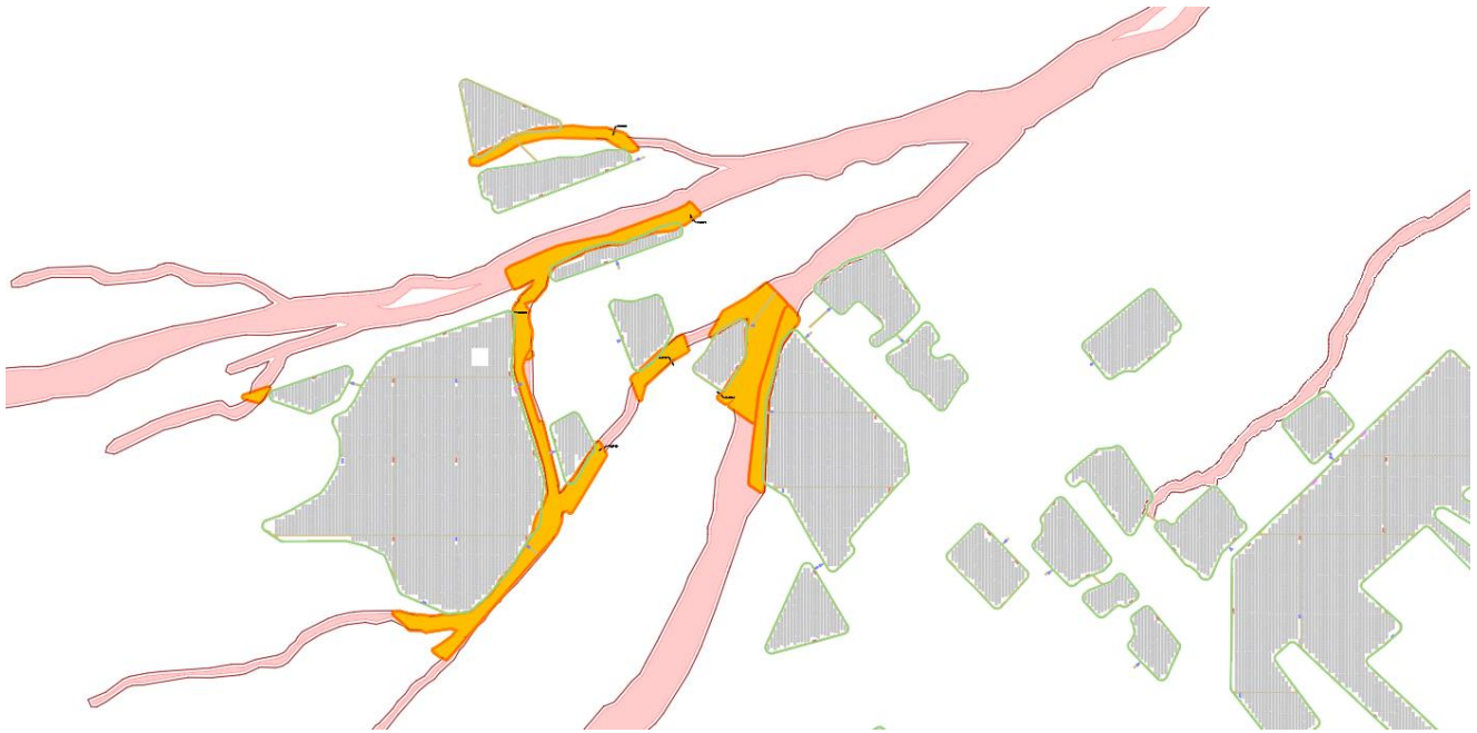
Figura 19 Impianto di progetto sovrapposto alle fasce PAI con relativo Buffer. In rosso Alta Pericolosità ed in Arancione media Pericolosità
