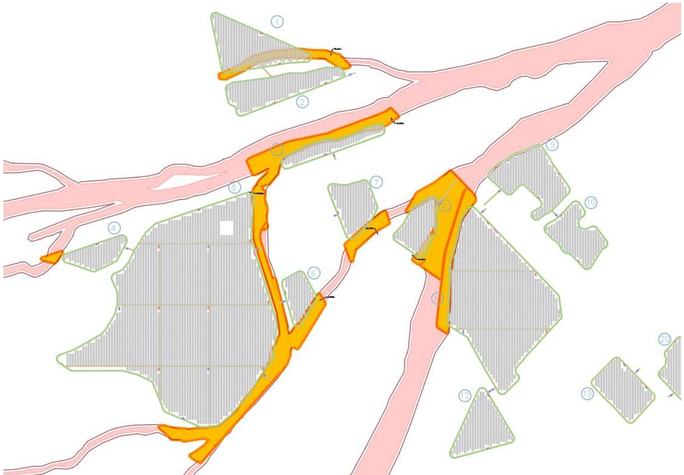
Figura 19 Impianto di progetto sovrapposto alle fasce PAI con relativo Buffer. In rosso Alta Pericolosità ed in Arancione media Pericolosità
