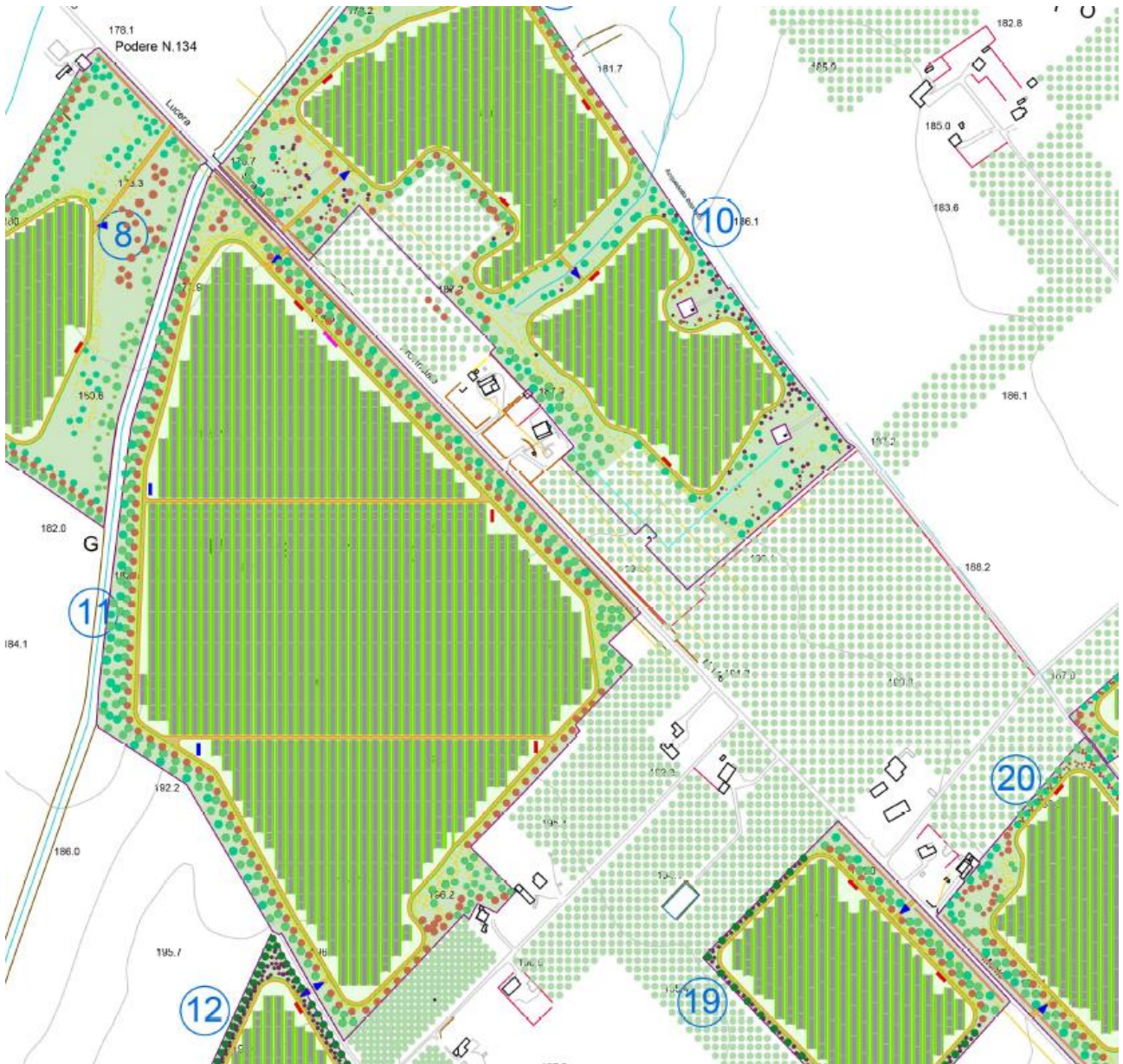
Figura 84 – Mitigazioni lungo le strade di attraversamento
