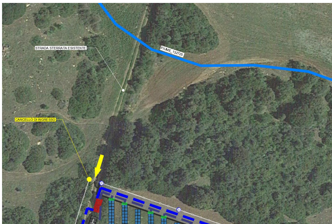
Figura 3 - Planimetria con risoluzione dell'interferenza tra reticolo FIUME 1327235 e impianto agro-voltaico
