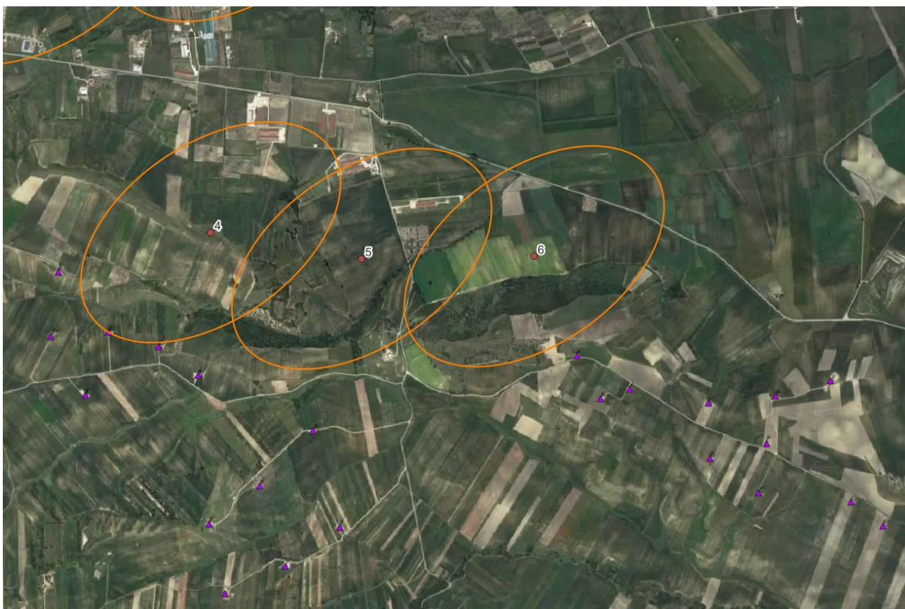
Figura 3 - Inquadramento dell'impianto di Sorgenia Renewables (in rosso) e dell'impianto della Voreas S.r.l.(in viola) con rappresentazione grafica delle distanze minime prescritte dal DM 10/09/2010 [Allegato 4, punto 3.2, lettera n)]: ellissi con semiassi di dimensione 5x3D.
