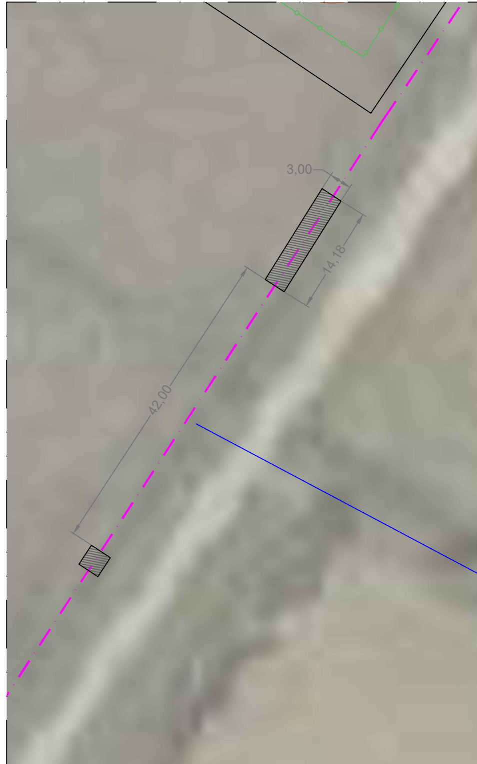
PARTICOLARE 2 - ATTRAVERSAMENTO IN T.O.C. LINEA DI CONNESSIONE ALLA RTN - CANALE GORA ZIRVA TERRAMAINI
