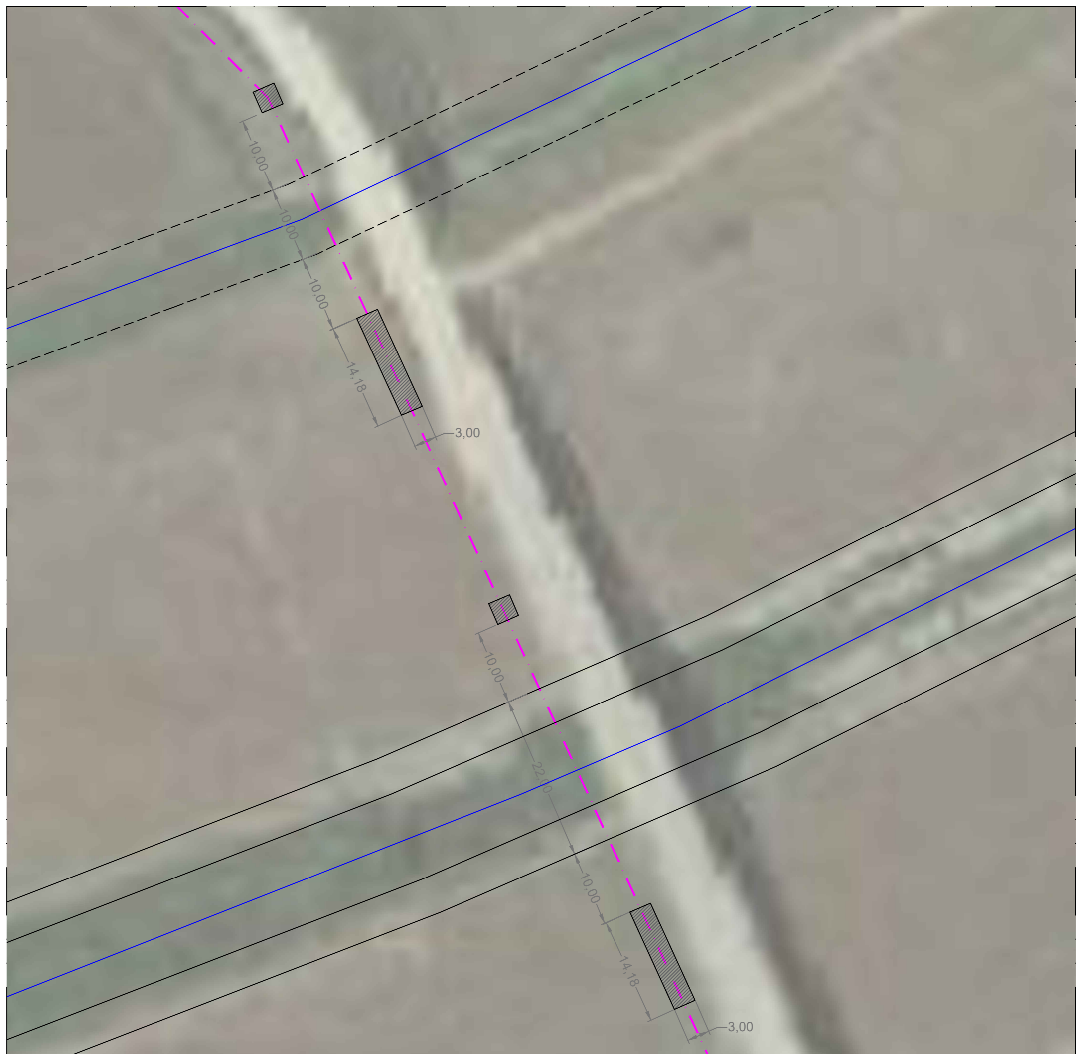
PARTICOLARE 2 - ATTRAVERSAMENTO IN T.O.C. LINEA DI CONNESSIONE ALLA RTN - CANALE GORA ZIRVA TERRAMAINI
