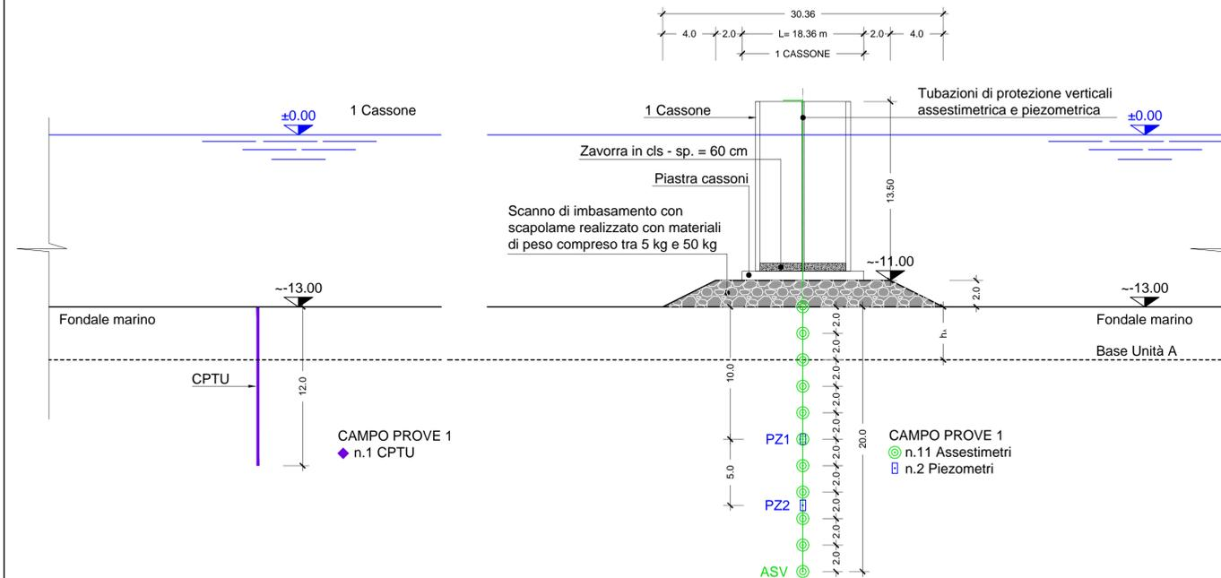
N.B.: "Il monitoraggio dei cedimenti sarà eseguito con rilievo topografico attraverso n. 3 mire topografiche da installare in testa al cassone. Due mire saranno installate su due spigoli del cassone ed una al centro".
