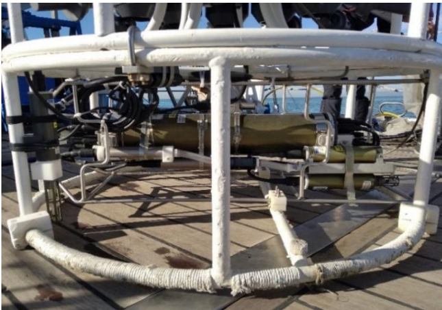
Figura 1.1.1. Sonda multi-parametrica (CTD) SBE 911 plus con multicampionatore di acqua Carousel SBE 32 con 12 bottiglie Niskin da 5 litri
