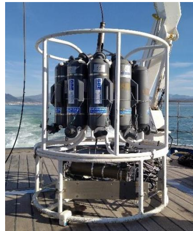
Figura 1.1.1. Sonda multi-parametrica (CTD) SBE 911 plus con multicampionatore di acqua Carousel SBE 32 con 12 bottiglie Niskin da 5 litri
