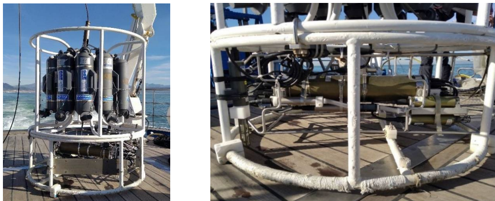
Figura 1.1.1. Sonda multi-parametrica (CTD) SBE 911 plus con multicampionatore di acqua Carousel SBE 32 con 12 bottiglie Niskin da 5 litri
