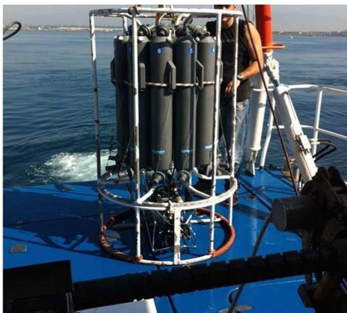
Figura 1.1.1.1. Sonda multi-parametrica (CTD) SBE 911 plus con multicampionatore d'acqua Carousel SBE 32 con 12 bottiglie Niskin da 10 litri.
