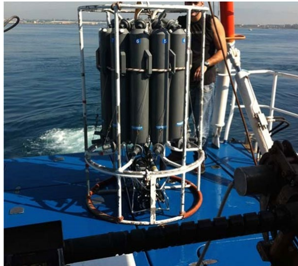
Figura 1.3.3. Sonda multi-parametrica (CTD) SBE 911 plus con multicampionatore d'acqua Carousel SBE 32 con 12 bottiglie Niskin da 10 litri.
