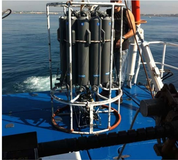
Figura 1.5.3. Sonda multi-parametrica (CTD) SBE 911 plus con multicampionatore di acqua Carousel SBE 32 con 12 bottiglie Niskin e da 10 litri.
