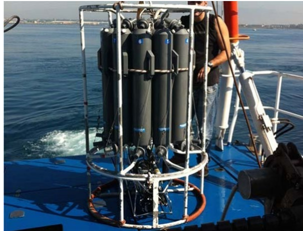
Figura 1.2.3. Sonda multi-parametrica (CTD) SBE 911 plus con multicampionatore d’acqua Carousel SBE 32 con 12 bottiglie Niskin da 10 litri.
