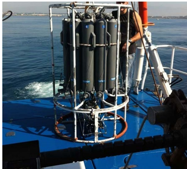
Figura 1.1.3. Sonda multi-parametrica (CTD) SBE 911 plus con multicampionatore d'acqua Carousel SBE 32 con 12 bottiglie Niskin da 10 litri.
