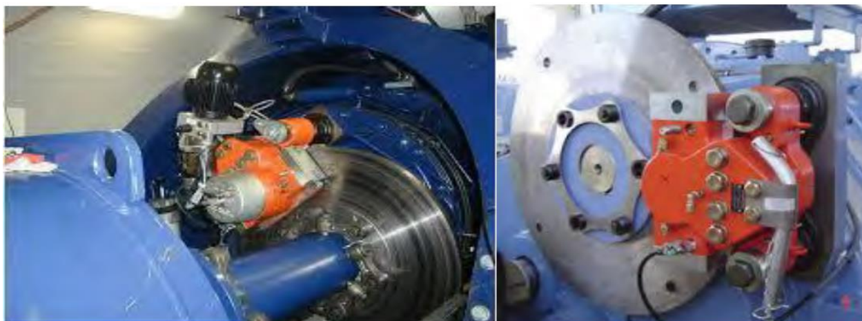
Figura 2.4: Sistemi di freno a disco sull'asse-rotore. Il sistema di controllo DTBird/Bat® invia un segnale di frenata del rotore che fa variare il passo delle pale, le pinze bloccano il movimento residuo della rotazione
