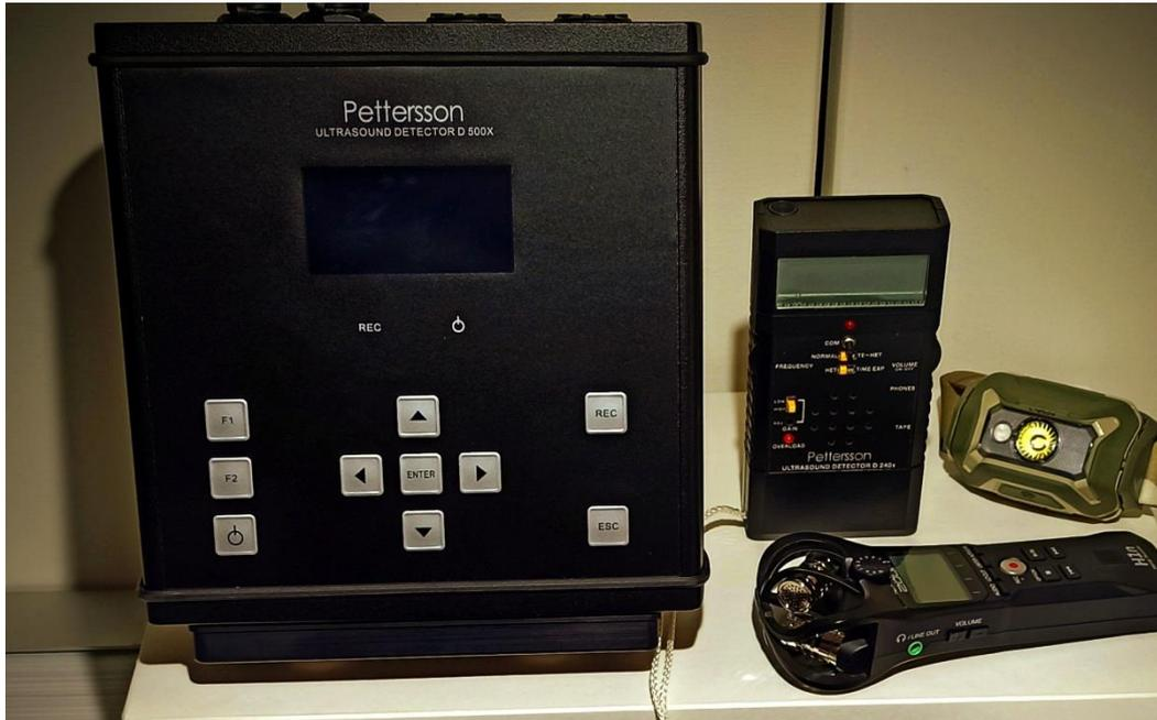
Figura 67 - Attrezzatura utilizzata per il monitoraggio dei chiroterri. Da destra verso sinistra: Bat detector D 500X per la registrazione prolungata in campo degli ultrasuoni. Rilevatore a eterodina ed espansione temporale (x10 e x20 selezionabile). Registratore multitraccia collegato al D 240X.
