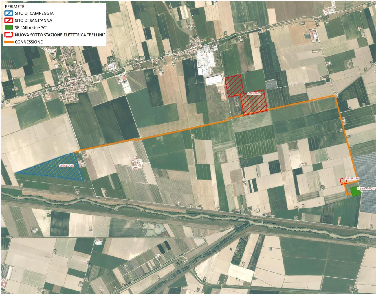
Nell'immagine satellitare di cui sopra, l'area occupata dai due impianti fotovoltaici è evidenziata in blu (Campeggia) e rosso (S. Anna), mentre è indicato con una linea arancione l'elettrodotto collegato in antenna a 30 kV su una futura nuova SSE Utente 30/132KV che a sua volta sarà connessa su di un futuro ampliamento della Stazione Elettrica (SE) della RTN a 132 kV denominata "Alfonsine SC", come indicato nella Soluzione Tecnica Minima Generale.
