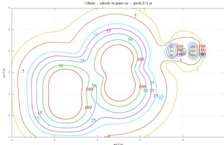
Si nota, come all'esterno del perimetro della cabina (avente lunghezza 6 m da quota x:0 a x: 6 e larghezza 2,5 m da quota y:0 a y: 2,5), i valori di concentrazione decrescono da 50  $\mu\text{T}$  fino a 3  $\mu\text{T}$  nel giro di 2,5-3 m da filo esterno cabina.
