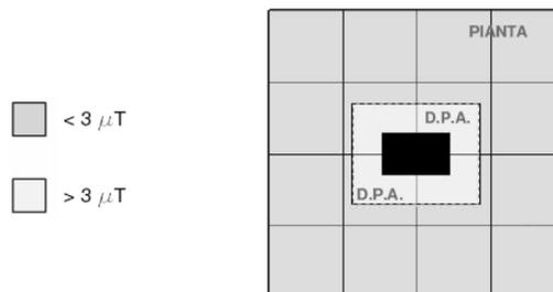
Oltre all'applicazione del metodo semplificato, modellizzando il cabinato mediante il software Magic della società Beshielding, implementando le apparecchiature presenti (quadri MT, trafo bt/MT, quadri bt e cavistica BT e MT di collegamento al trafo) secondo la dislocazione interna prevista, il risultato viene, di seguito, proposto.
