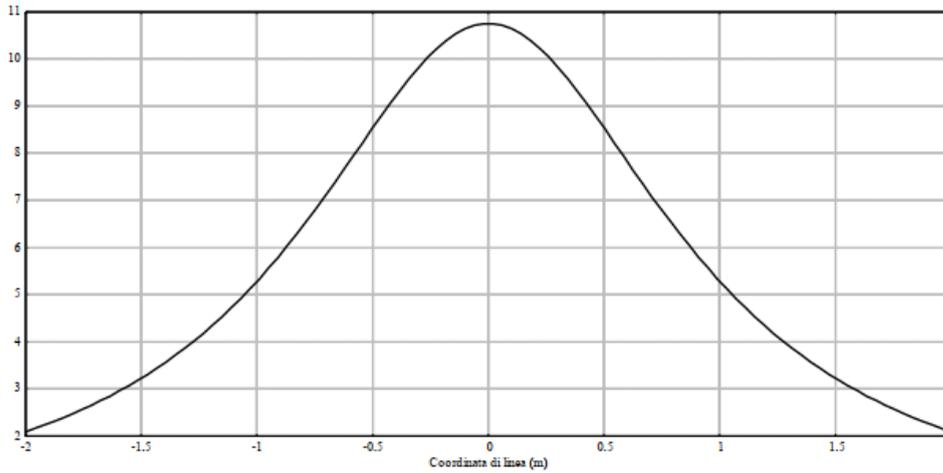
Si denota, come in corrispondenza dell'asse del cavidotto ( $x: 0$  m), il valore si attesta attorno a  $10,5 \mu\text{T}$ , per poi decrescere simmetricamente su ambo i lati, rimanendo sotto il valore di  $3 \mu\text{T}$  nella fascia compresa da  $-1,6$  e  $1,6$  m rispetto ad asse terna di cavi.
