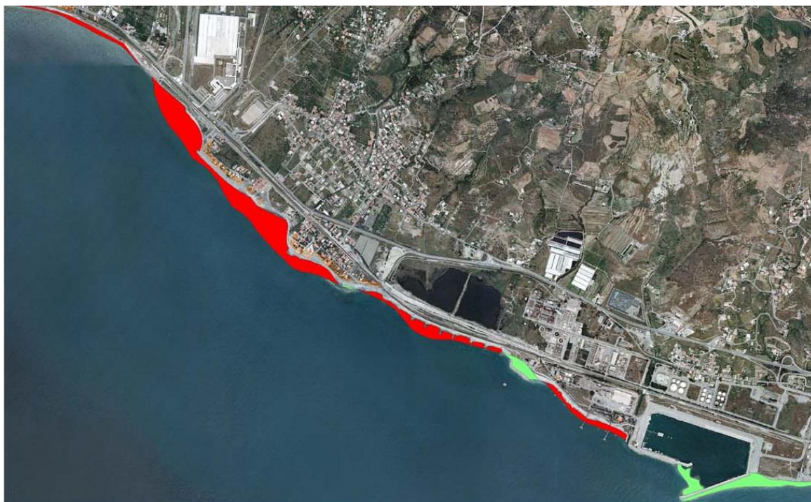
Figura 21 Estratto del Piano Stralcio di Bacino per l'Assetto Idrogeologico nella Regione Calabria: aree a rischio erosione costiera nel Comune di Montebello Ionico
