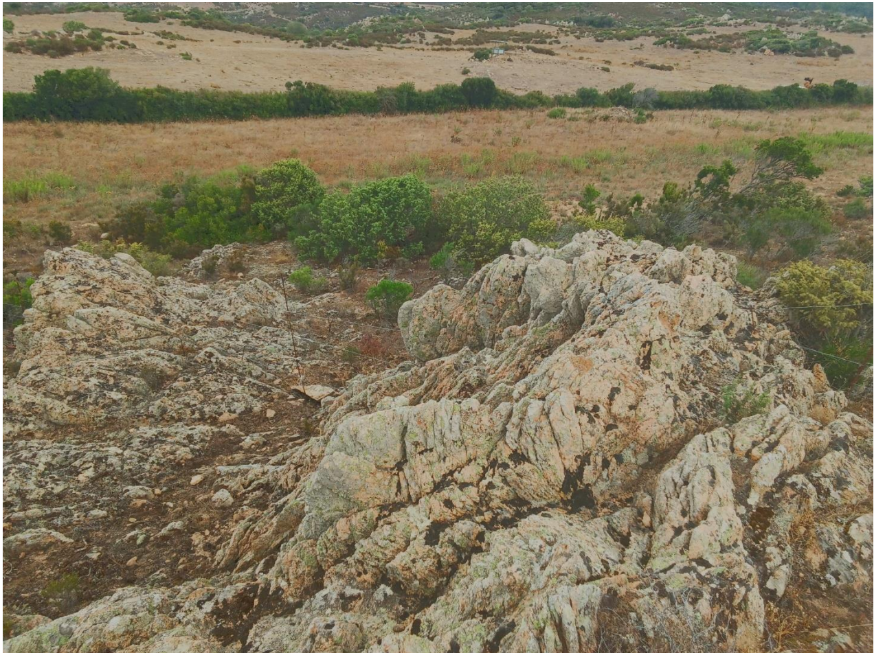
Figura 18: Affioramento del complesso granitico della Gallura (Unità intrusiva Arzachena) situato ad una Distanza di circa 350 m a sud dell'aerogeneratore WTG4. Il complesso come nella figura precedente presenta numerosi sistemi di fratture ad alto angolo e localmente spaziature dell'ordine dei centimetri. Oltre Alla fratturazione di tipo meccanica è molto evidente l'alterazione chimica che conferisce al complesso granitico una colorazione di tipo giallastro. In corrispondenza di fratture con grado di fratturazione maggiore l'alterazione risulta maggiormente più spinta.
