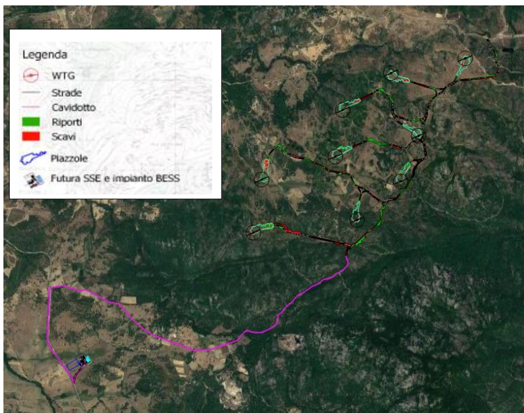
Figura 2 - Localizzazione degli aerogeneratori su ortofoto
