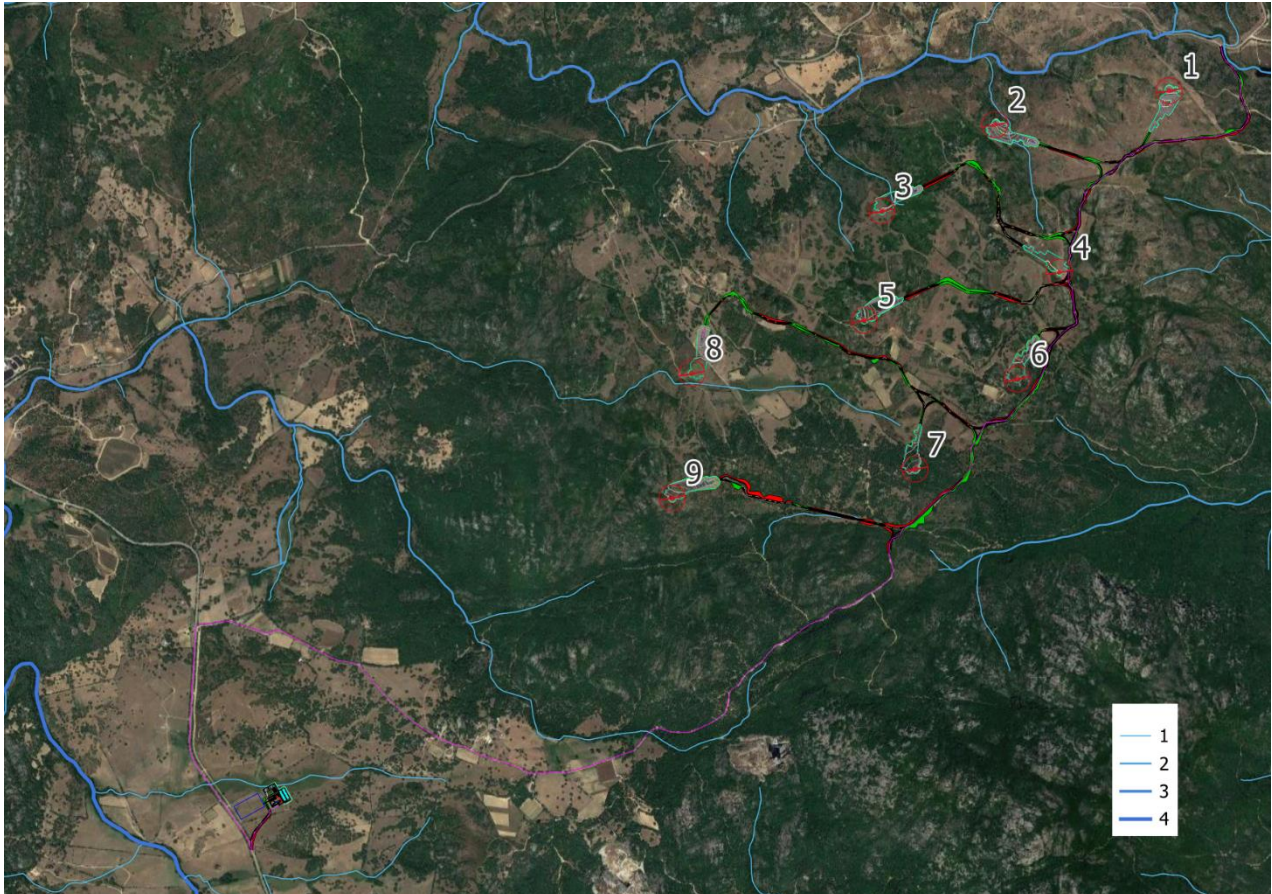
Figura 26: Reticolo idrografico dell'intera area; nella figura, elaborate in ambiente GIS, vengono riportati gli ordini Horton-Strahler secondo quanto riportato nel SITR della Regione Sardegna.
