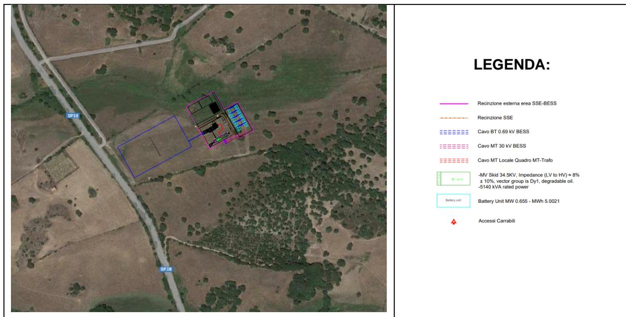
**Figura 2: Localizzazione area di impianto BESS e SSE su base ortofoto**
