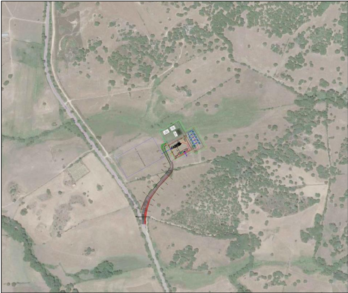
Figura 11 - Tracciato planimetrico viabilità di nuova realizzazione. Fonte: elaborato di progetto "C23ANTW001P020T00_Planimetrie e profili degli scavi, degli sbancamenti e dei rinterri"
