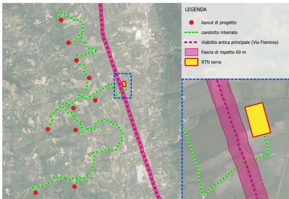
Figura 1: inquadramento delle opere in progetto rispetto alla fascia di tutela della via Flaminia
