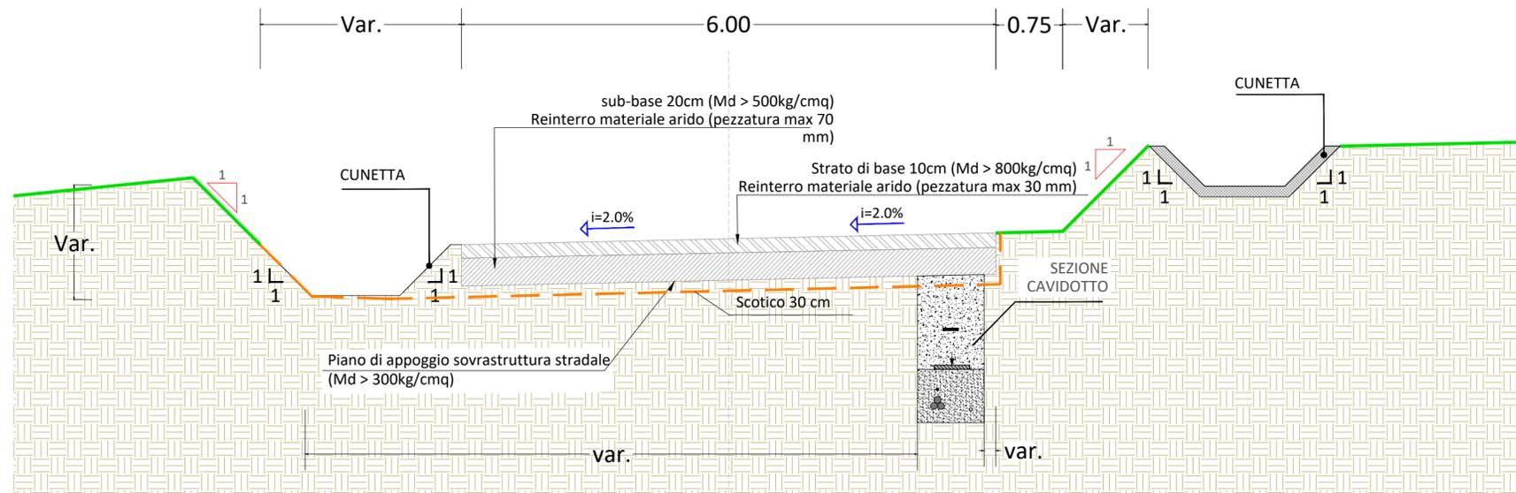
SEZIONE TIPICA VIABILITÀ DA REALIZZARE A MEZZA COSTA E SEZIONE CAVIDOTTO AD DI SOTTO DELLA SEZIONE STRADALE
