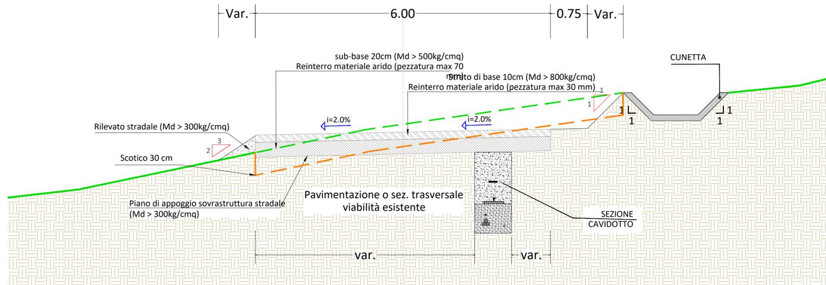
SEZIONE TIPICA VIABILITÀ DA REALIZZARE IN RILEVATO E SEZIONE CAVIDOTTO AL DI SOTTO DELLA SEZIONE STRADALE
