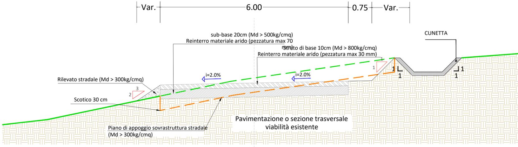
SEZIONE TIPICA VIABILITÀ DA REALIZZARE IN RILEVATO
