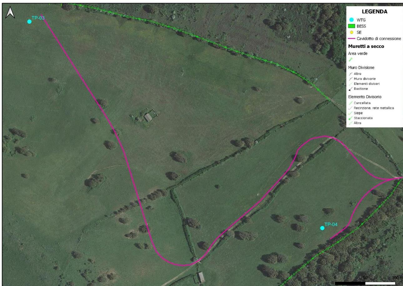
Figura 2: Interferenza cavidotto di connessione interno con Muretti a secco
