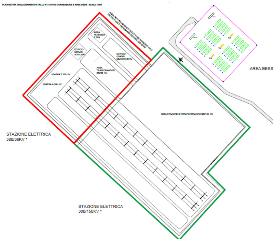
Figura 88 - Planimetria inquadramento stallo di connessione alla RTN (area in rosso) e area BESS dell'impianto in oggetto
