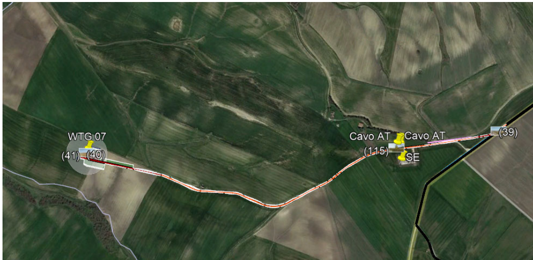
Figura 66 – Layout di impianto turbina sette
