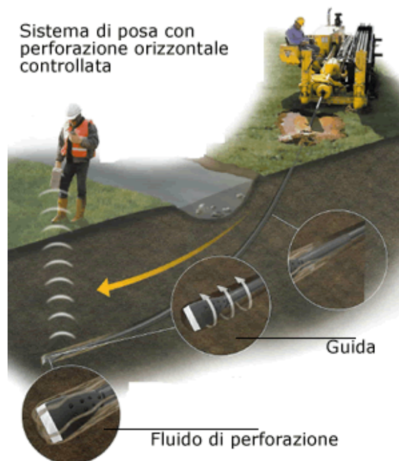
Figura 15 - Sistema di trivellazione orizzontale controllata (T.O.C.).
