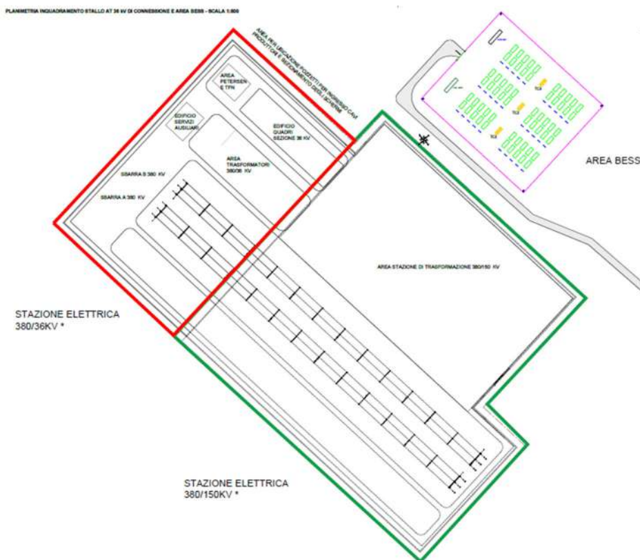
Figura 26: Planimetria inquadramento stallo e BESS
