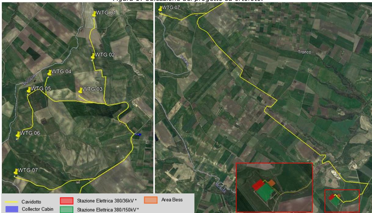
Figura 2: Ubicazione tracciato del cavidotto su ortofoto.
