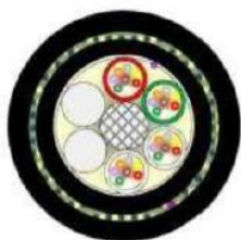
Figura 9: Sezione cavo con 48 fibre ottiche
