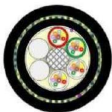
Figura 13: Sezione cavo con 48 fibre ottiche.
