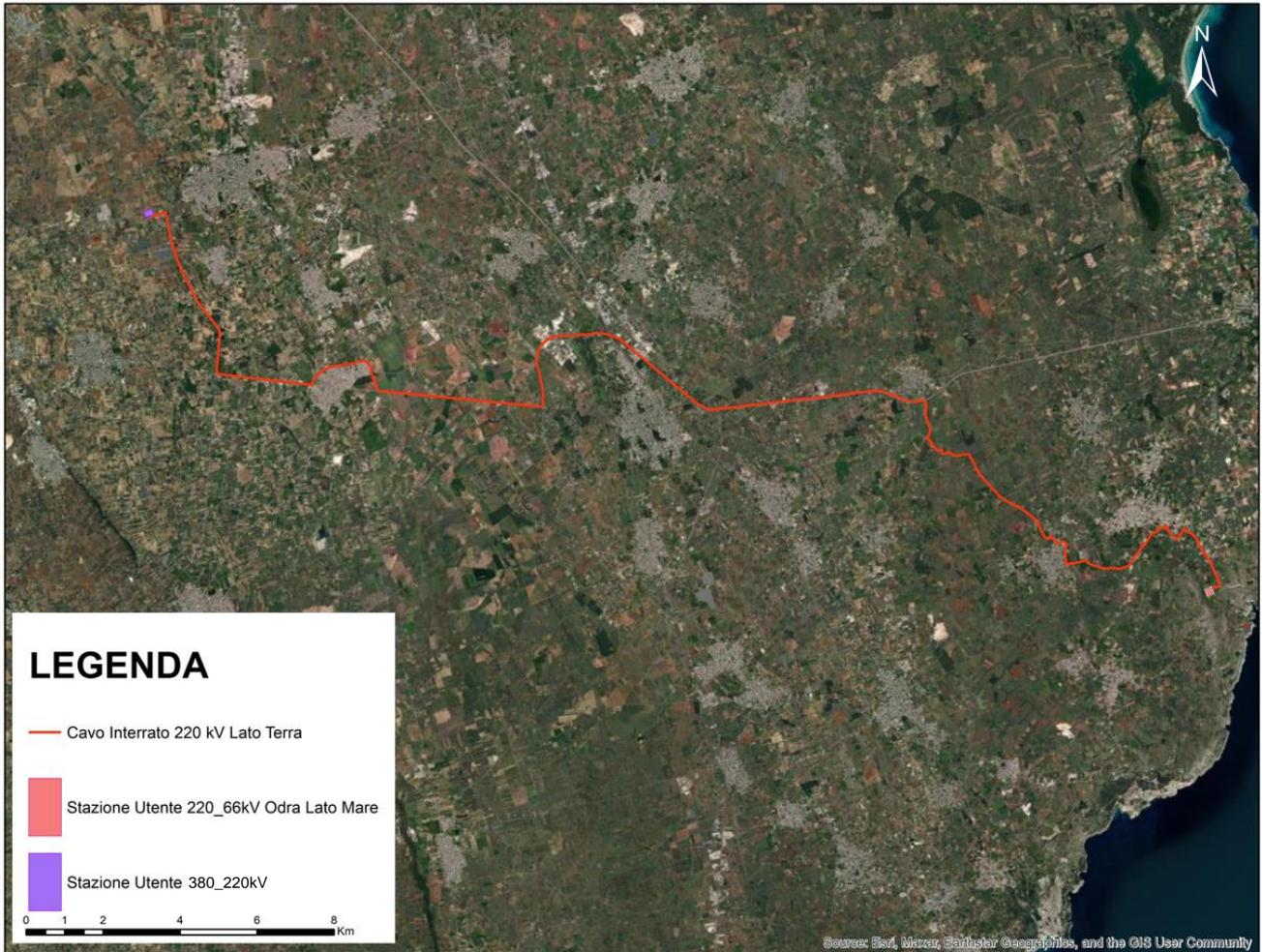
**Figura 34: Cavo interrato di connessione 220 kV tra la Stazione di Trasformazione Elettrica Lato Mare e la Stazione Elettrica Lato Connessione RTN.**
