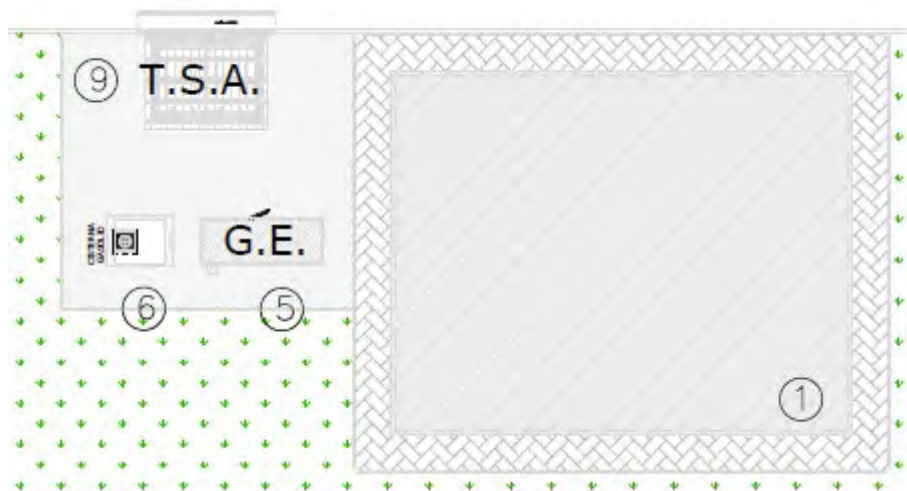
Figura 31: Estratto non in scala da elaborato ODR.ENG.TAV.053.00_ Sottostazione elettrica Lato Connessione – Planimetria e sezioni elettromeccaniche_Tav. 1/2. Planimetria aree locali GE e TSA
