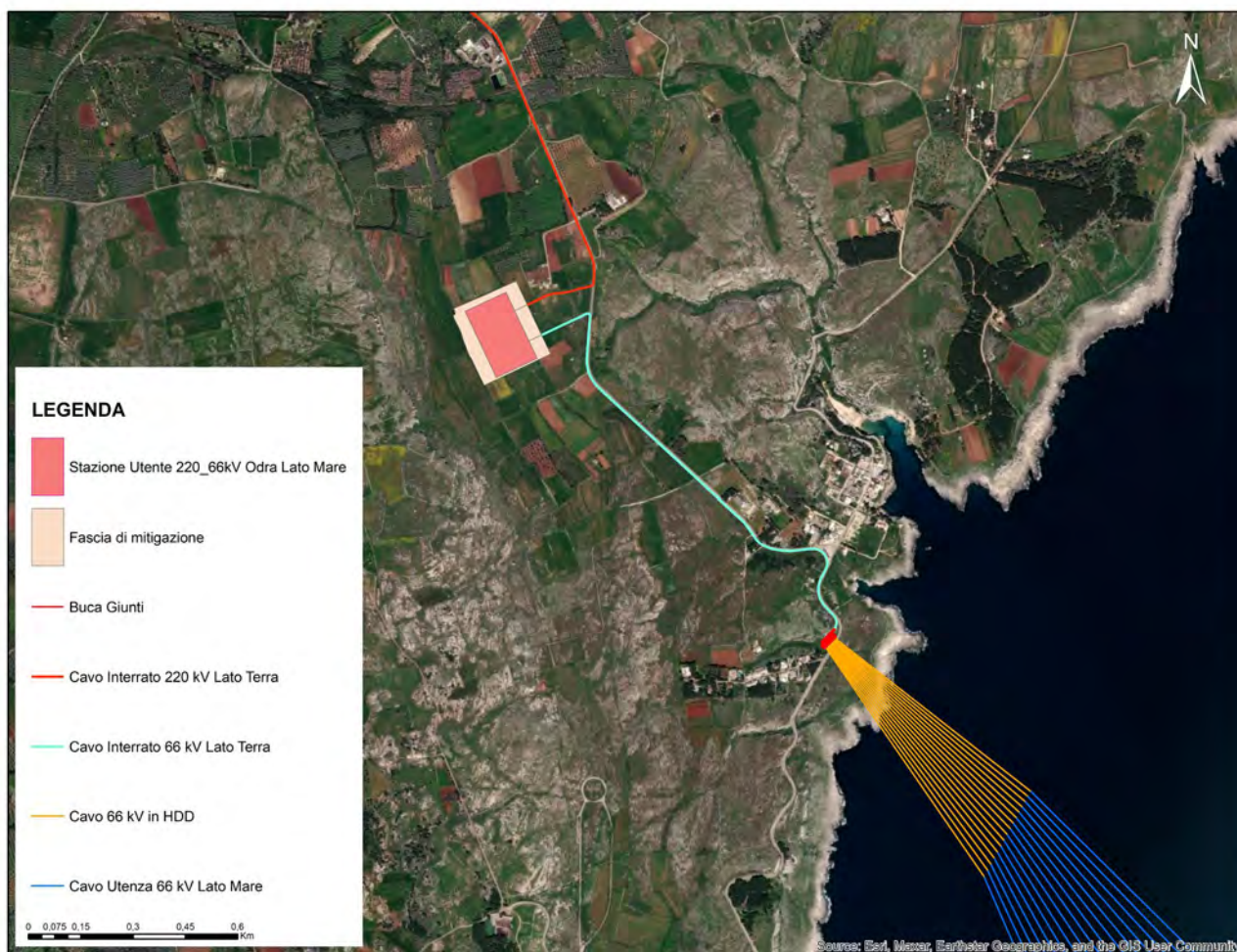
Figura 4: Cavo interrato di connessione 66 kV tra il punto di approdo e la Stazione di Trasformazione Elettrica Lato Mare.
