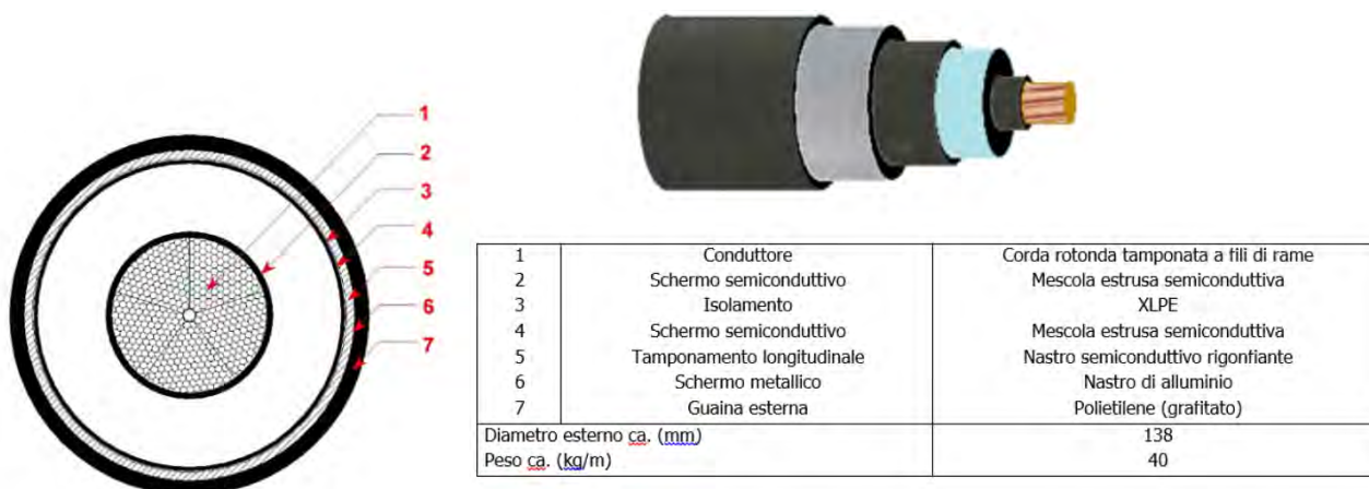
Figura 33: Sezione indicativa del cavo che verrà utilizzato
