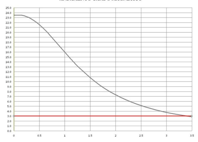
Valore dell'induzione magnetica al suolo del cavidotto MT nel tratto a 3 terne con disposizione in piano. Distanza dall'asse di posa dei cavi espressa in metri [m].
