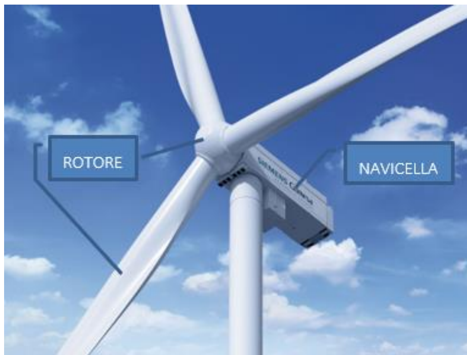
Figura 2.1: Rappresentazione di un aerogeneratore.
