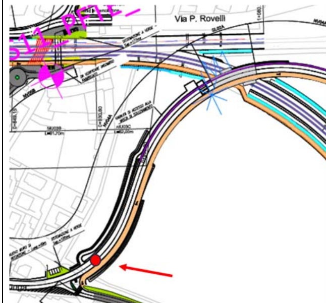
SONDAGGIO IN ASSE ALL'OPERA NIO1 SULLA SP591 bis
